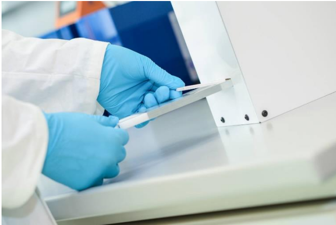
Abb. 1 Der Testchip wird nach dem Aufbringen der Probe in den Analysator gesetzt. Hier wird dieser auf 62 °C erwärmt, sodass die Reaktion stattfinden kann.
